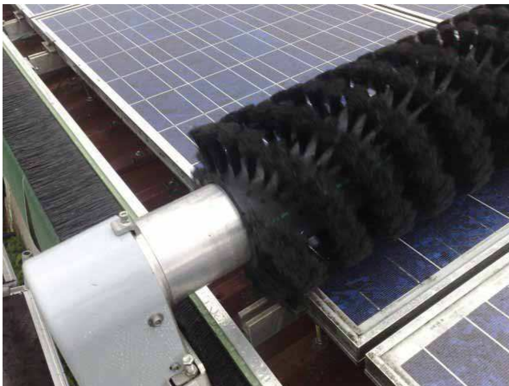
Rys. Bezwodna technologia czyszczenia paneli fotowoltaicznych.
